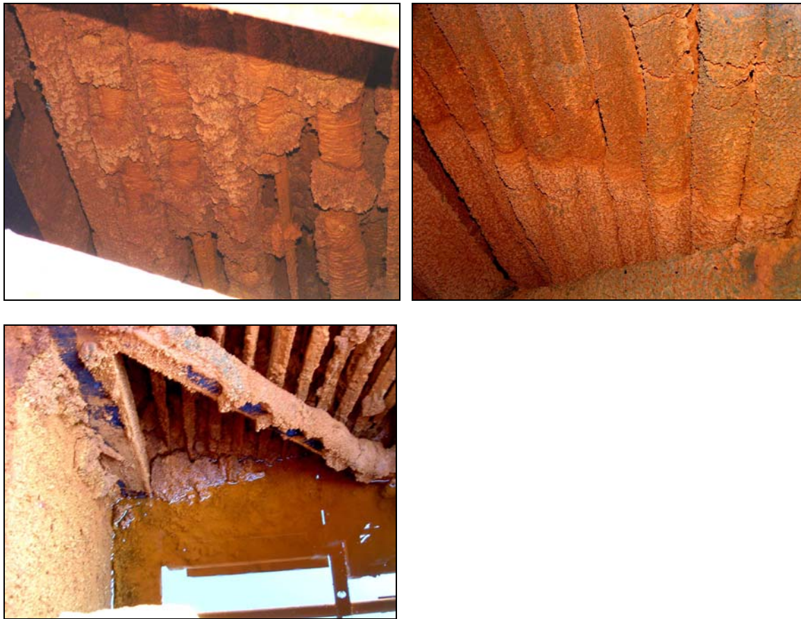
Abbildung 30: Aufnahmen aus dem Oxidationsbecken nach Stilllegung der Versuchsanordnung Anfang November 2006 Der gesamte Oxidationsraum ist sehr stark zugewachsen.
