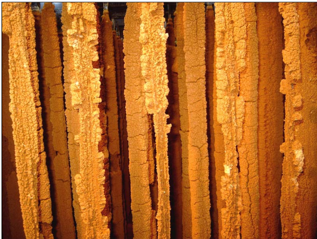
Abbildung 54: Mit EHS bewachsene Aufwuchsträger in der Pilotanlage
